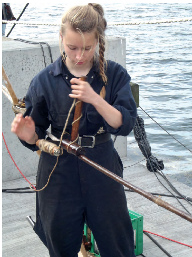
Klajdowanie liny na żaglowcu „Georg Stage II”, Aalborg, 2015 r. Fot. Tomasz Maracewicz
